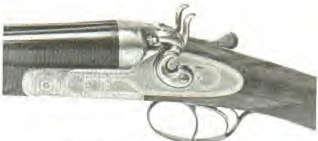
Klasična oruzara - nema vidljive kočnice.
